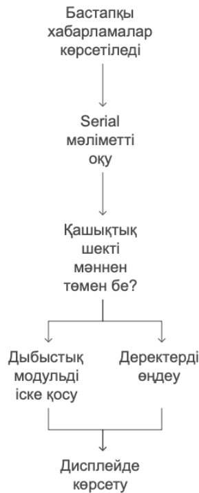
4.2-сурет – Arduino Nano-ның жұмыс логикасы
