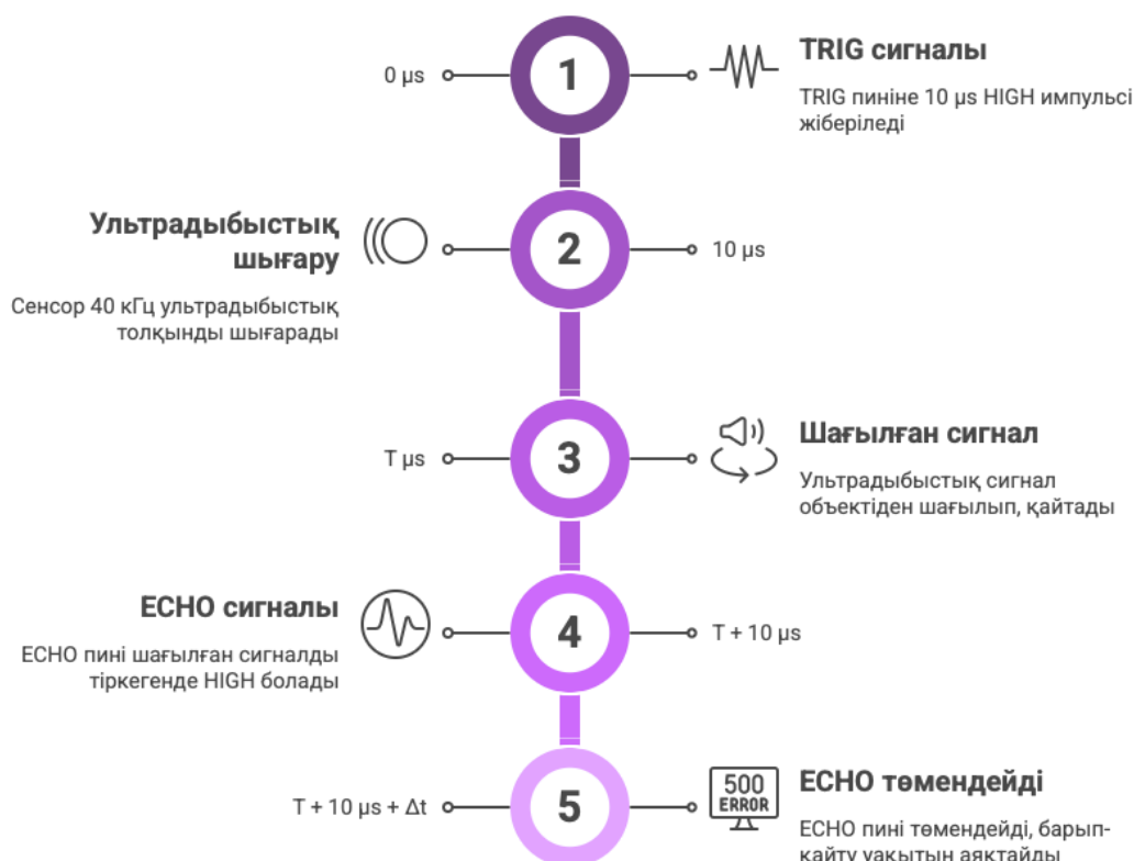
2.3-сурет – HC-SR04 ультрадыбыстық қашықтық өлшеуіштің жұмыс процесі
