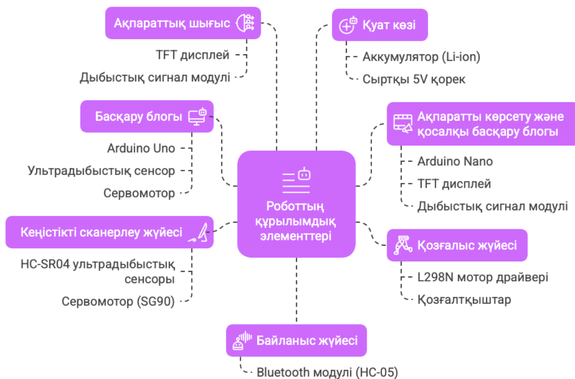
3.2-сурет – Роботтың негізгі құрылымдық элементтері
